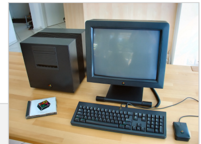
NeXTcube – 30,5 cm Magnesiumgehäuse, entworfen von Hartmut Esslinger
